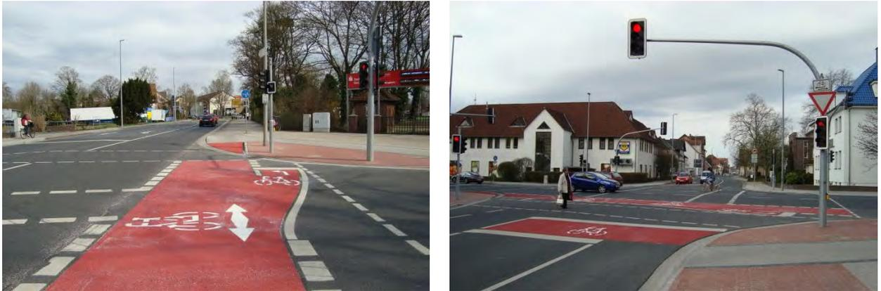
Abb. 52 Beispiel für direktes Linksabbiegen (links) und einen aufgeweiteten Radaufstellstreifen (rechts – Burgdorf, Region Hannover)
