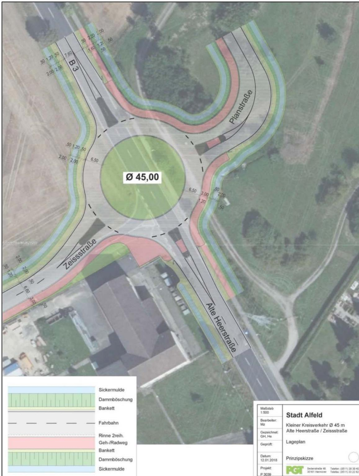
Abb. 1: Ausbauvariante Kreisverkehr gem. PGT 2018 (unmaßstäblich vergrößert)
